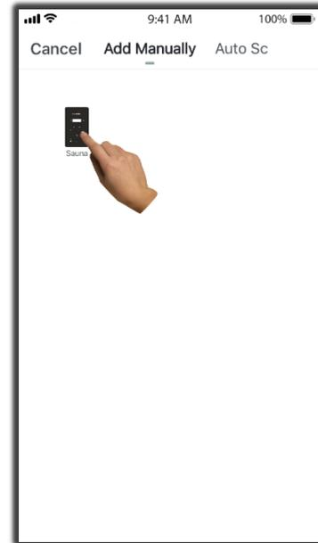
6) Die Steuerung der SaunaLogic2 in den Koppelmodus schalten. Dazu die Bluetooth-Taste drücken, bis „con“ auf dem Steuerdisplay angezeigt wird. Die Bluetooth-Taste erneut drücken und halten. Bei Ertönen eines Signal freigegeben. Dann auf der App die Steuertaste zum Bestätigen des Modus „con“ antippen.
